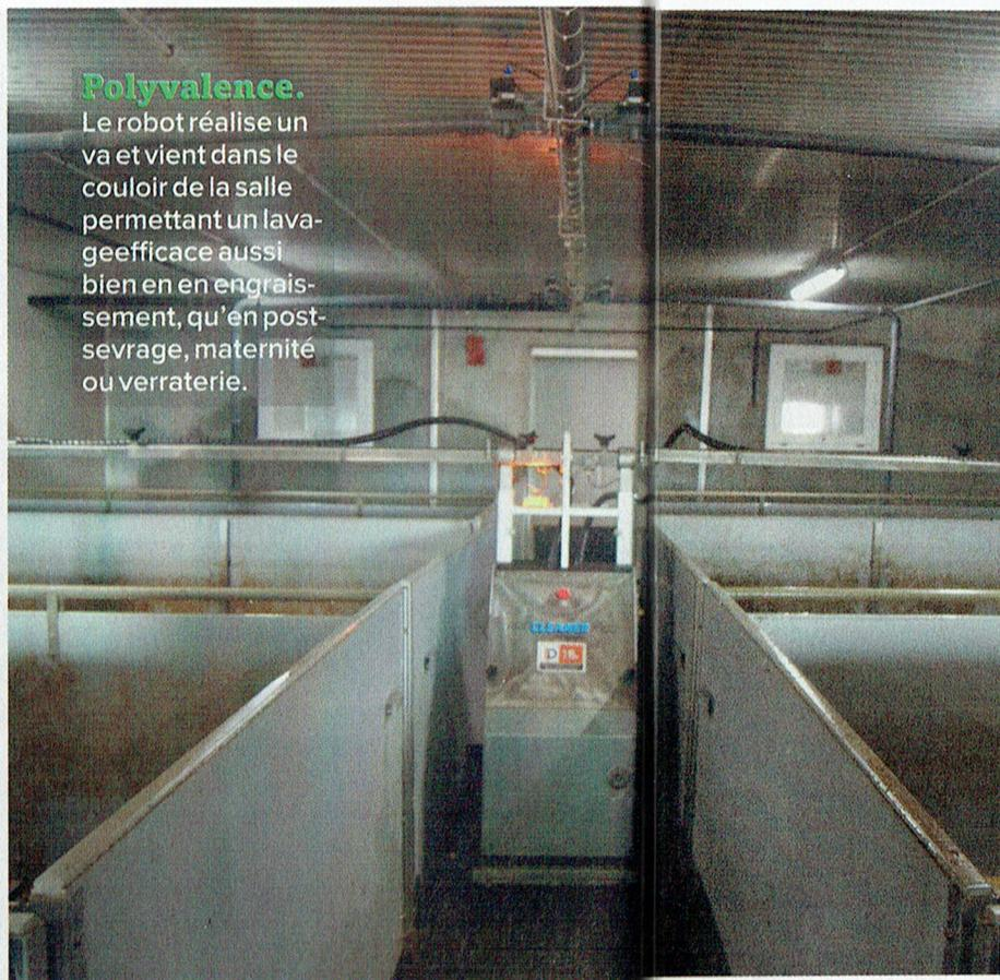
**Polyvalence.** Le robot réalise un va et vient dans le couloir de la salle permettant un lavage efficace aussi bien en engraissement, qu'en postsevrage, maternité ou verraterie.
