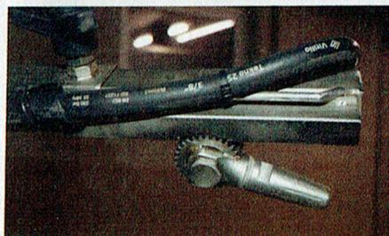
**Buses.** Le robot est équipé de deux buses puissantes, qui permettent un jet jusqu'à 4 mètres.
