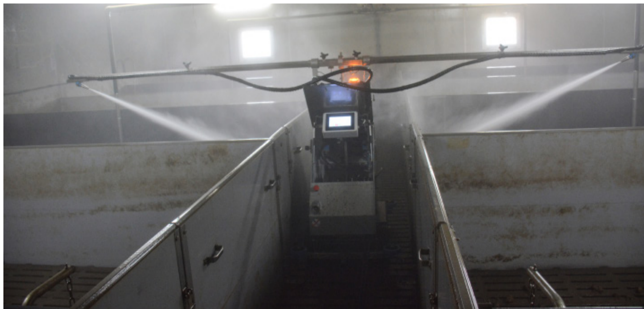
Avec ses 2 buses, le robot lave les cases des 2 côtés simultanément.
