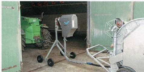
Une fois la remorque placée à l'entrée du bâtiment, le chariot est tiré jusqu'au pignon opposé, entraînant le déroulement du tuyau d'eau de 130 mètres de long. Le retour du chariot est assuré par l'enrouleur automatique. La base est branchée à l'alimentation en eau et en électricité du sas. La pompe est réglée à un débit d'eau de 40 L/min à une pression de 10 bars (maxi 12 bars). La consommation d'eau maximale est de 70 L/min.
