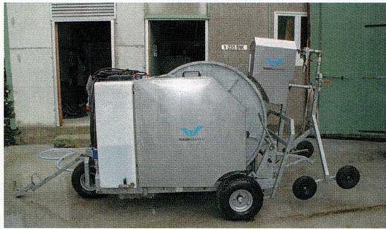
Fixé sur une remorque d'attelage facile à manier avec sa roue avant pivotante, le robot Procleaner P200 fabriqué en acier galvanisé est constitué d'une base fixe (comprenant l'enrouleur, le réservoir d'eau et la pompe), et un chariot sur batterie, les deux communiquant par wifi (poids total de 800 kg).
