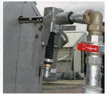
La buse (calibre 6,4) projette un jet puissant jusqu'à 12 mètres de long et balaye la coque d'une paroi à l'autre. Son axe de rotation de 360° permet de laver également le sol dans le cas d'une dalle bétonnée. La vitesse de balayage et l'angle de lavage sont réglables (trajectoires en oscillations du jet) pour améliorer l'efficacité du lavage dans les zones moins accessibles (les trappes par exemple). La programmation est réalisée à partir d'un écran tactile.
