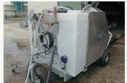
La réserve d'eau de 400 l assure un débit optimal. Il est équipé de deux capteurs bas et haut de remplissage.
